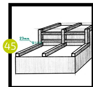
Монтаж ступени осуществляется при помощи металлического стартового кляймера коллекции SINGARAJA и уголка размером 50\*50\*35 мм.
