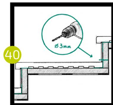
После предварительного просверливания прикрепляем подступёнок шурупами размером 3,5\*35 мм (41).
