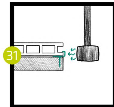
Торцы настила закрываются при помощи завершающего уголка.
