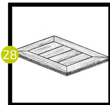
Еще торцы настила можно закрыть при помощи завершающего уголка. Тогда ступень с дополнительными лагами не используется.
