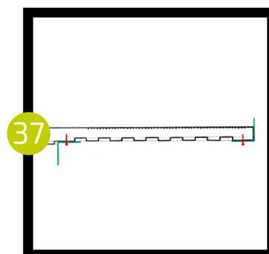
После этого, кладём ступень на опорные лаги, и прикручиваем уголки к лагам саморезами размером 3,5\*25 мм (38).
