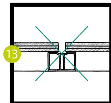
Опорные лаги, при необходимости их продолжения, укладываются внахлест друг за друга на 150 мм (14), либо кладутся по той же линии с оставлением зазора 3-5 мм между торцами несущих лаг (15).
