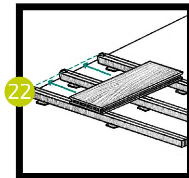
Далее доска закрепляется при помощи металлического рядного кляймера.
