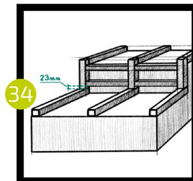
Переворачиваем ступень, отступаем 13 мм от края капиноса, подставляем уголок размером 50\*50\*35 мм и отмечаем место для предварительного засверливания. Далее, сначала просверливаем ступень на 19 мм сверлом диаметром 3 мм, после этого прикрепляем уголок шурупом размером 3,5\*19 мм (35).
